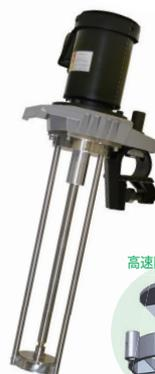
粉の塊を壊す・溶かす性能を強化したポータブルミキサーです。従来の可搬型にない特殊構造で強力な分散・溶解性能を発揮します。高速回転するロータと固定翼のステータで構成された特殊攪拌翼は、それぞれに備わった4枚ブレードにより高い剪断作用を生み出します。分級プロセスの前処理としての使用も効果的です。
